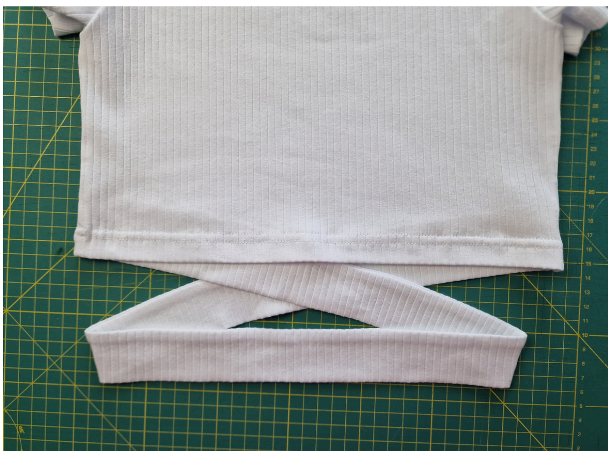
20. Dolní kraj zadního dílu v kraji prošijte . Šijte od bočního švu přes zadní díl k druhému bočnímu švu. Poté doporučuji šití na obou stranách zajistit proti páráni buď zapožitím nebo uzávěrkou.
